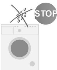
● Транспортировка До начала работ, связанных с транспортировкой, отсоедините стиральную машину от электросети. Установите транспортные болты и приспособления, предохраняющие машину на время транспорта. См. раздел УСТАНОВКА СТИРАЛЬНОЙ МАШИНЫ на стр. 6. Разрешается транспортировать стиральную машину только в вертикальном положении.
