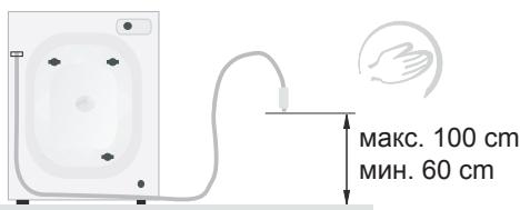
Сливной шланг находится сзади стиральной машины. Закрепите сливной шланг таким образом, чтобы он не перемещался во время работы стиральной машины (используйте для этого колено, как показано ниже). Не опускайте конец сливного шланга слишком глубоко в водосток!
