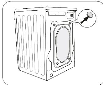
● Отвинтите при помощи ключа 4 транспортных болта.
